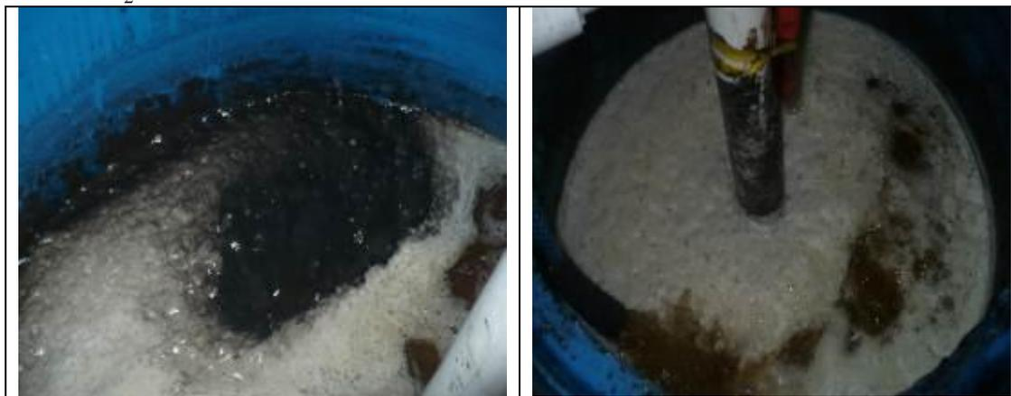
Также наблюдалось появление труднорастворимого темно-коричневого налета, представляющего собой комплексных соединений железа, на стенках промежуточной емкости и на поверхности промывочного раствора, что свидетельствует об удалении ржавчины с внутренней поверхности жаровых труб котла.
