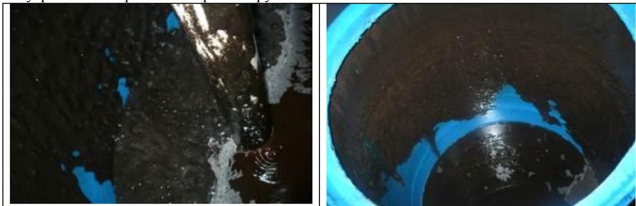
В процессе очистки отложения переходят в растворимое состояние и выводятся из оборудования вместе с промывочным раствором, о чем свидетельствует изменение цвета раствора, образование пены, и изменение pH промывочного раствора.
